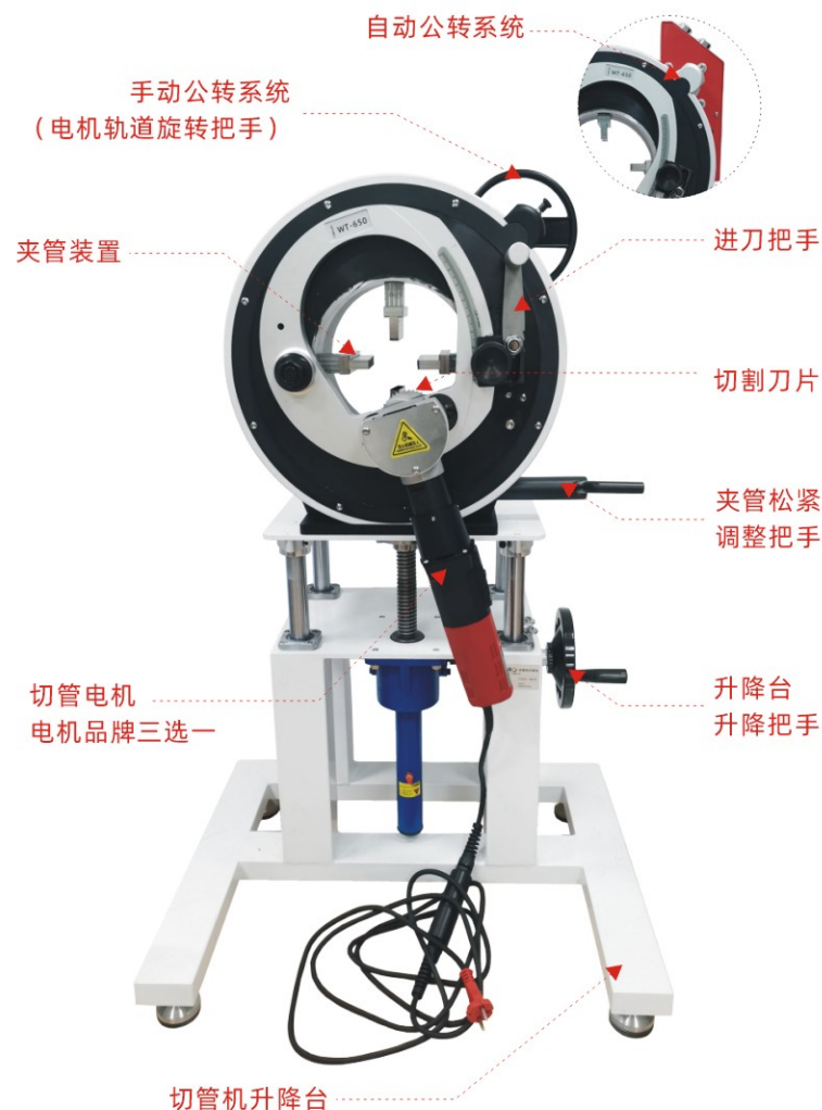
WT系列行星式切管机整机及部件功能图
